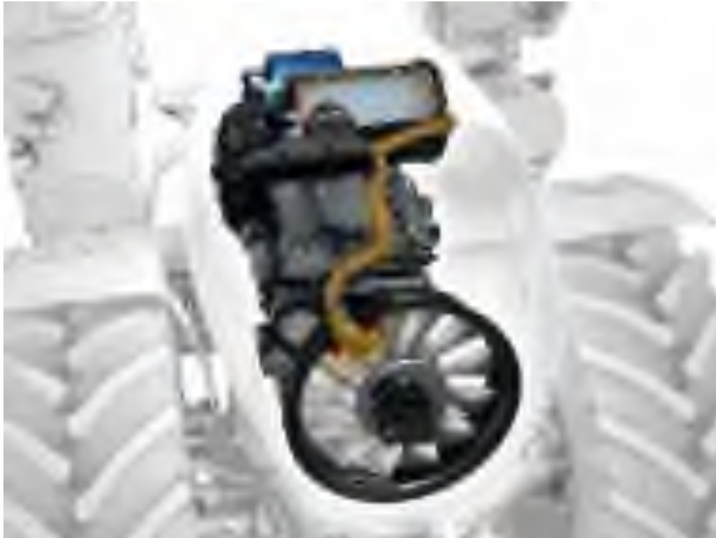
Фільтр повітря для самостійного очищення в Fendt 1000 Vario
