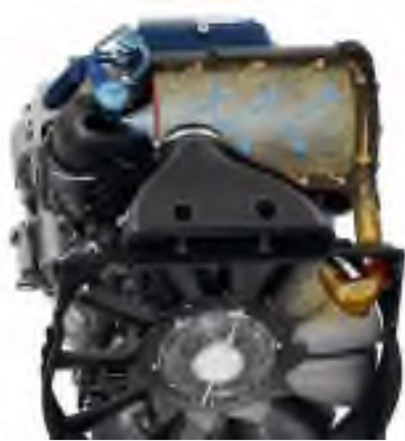
Фільтр повітря для самостійного очищення в Fendt 900 Vario
