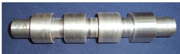
Рис. 3. Плоскі (а) і круглий (б) зразки зі сталі 40
