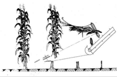
Рис. 1. Принципова схема качановідокремлювача з вертикальними вальцями і примусовим введенням стебел
