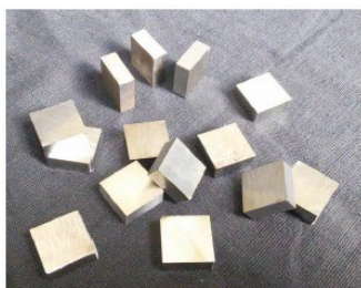
Рис. 3. Плоскі (а) і круглий (б) зразки зі сталі 40
